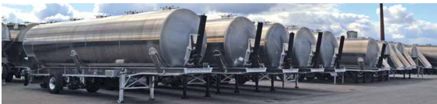
In Reih und Glied: verschiedene Feldbinder-Silofahrzeugvarianten (liegend und kippar) kurz vor ihrer Fertigstellung
